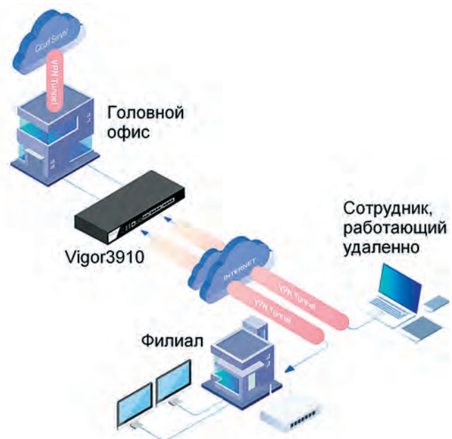
Рис. 1. Коммутируемое соединение и подключение LAN-to-LAN – типовые сценарии использования VPN
